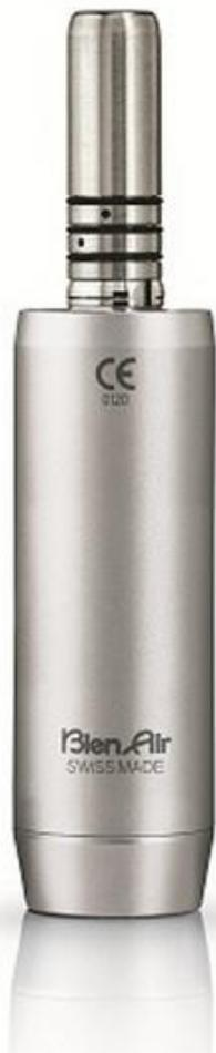
Когда приходит время замены щеток в электрическом микромоторе, мало просто их заменить, нужно обязательно хорошо очистить микромотор от остатков графита. Если этого не сделать, микромотор будет греться и быстро выйдет из строя. Именно, по этому даже простая замена щеток должна производиться квалифицированным инженером.
